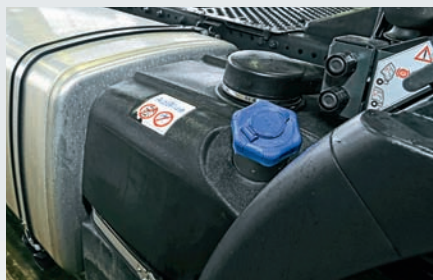
↑ Отдельный бак под AdBlue – признак современного дизельного автомобиля.
