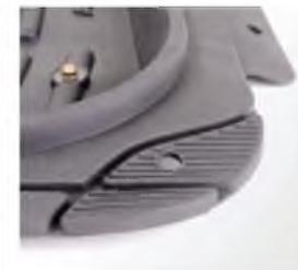
Отверстия для фиксации ковриков напольными крючками автомобиля.
